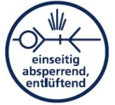
Gekuppelt wird drucklos. Dabei ist lediglich eine geringe Federkraft zu überwinden. Erst wenn die grüne Hülse nach vorn geschoben wird, kann sich der Druck aufbauen. In dieser Position ist es unmöglich, versehentlich oder bewusst zu entkuppeln. Wenn die Verschiebehülse wieder in ihre Ausgangsposition gebracht wird, entlüftet sich der Schlauch und der Anschluss kann gelöst werden.
